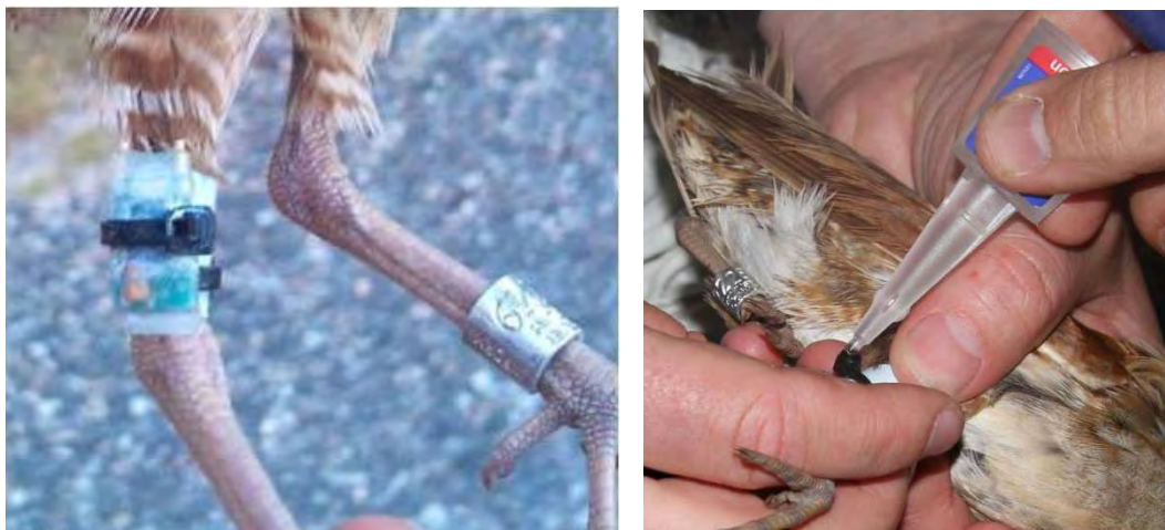
Figur 2. Vänster; en ljuslogger monterad på en kornknarrs tibia på Gotland sommaren 2011. Höger; ett buntband används för att säkra ringen som loggern är fäst vid. Klister appliceras därefter i buntbandets lås. Foton: Ulf Stähle.
